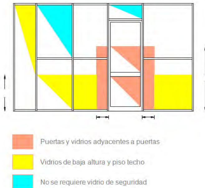
Figura 8: Ubicación de Vidrio de Seguridad en una Mampara
